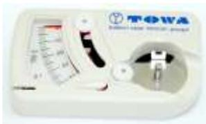
Spulkapsel - Fadenspannungsmeßgerät
